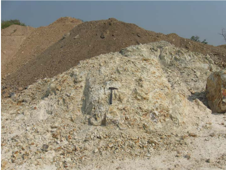
รูปที่ 15 แสดงลักษณะแร่หินอุตสาหกรรมชนิดหินไรโอไลต์เพื่ออุตสาหกรรมเซรามิก ในพื้นที่คำขอ ประทานบัตรที่ 6/2561 หมายเลขหลักหมายเขตเหมืองแร่ที่ 30539 บริเวณค่าพิกัด 560330E 2045381N มอง ไปทางด้านทิศตะวันตกเฉียงเหนือ
