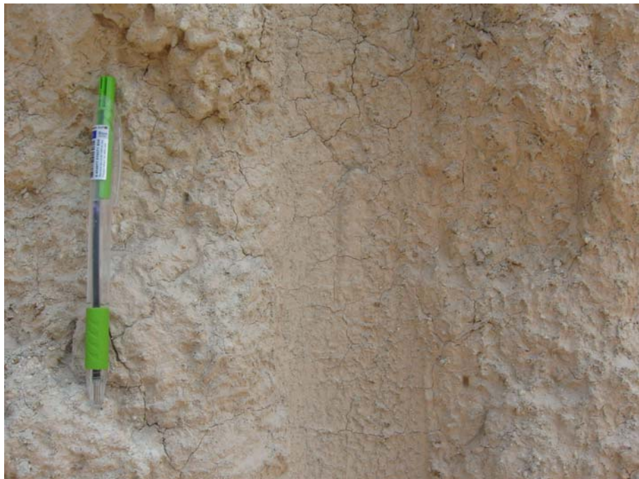
รูปที่ 18 แสดงลักษณะหินอุตสาหกรรมชนิดหินไรโอไลต์เพื่ออุตสาหกรรมเซรามิก สีขาวอมชมพู ก่อนข้างผุ ในพื้นที่คำขอประทานบัตรที่ 6/2561 หมายเลขหลักหมายเขตเหมืองแร่ที่ 30539 บริเวณค่าพิกัด 560330E 2045381N
