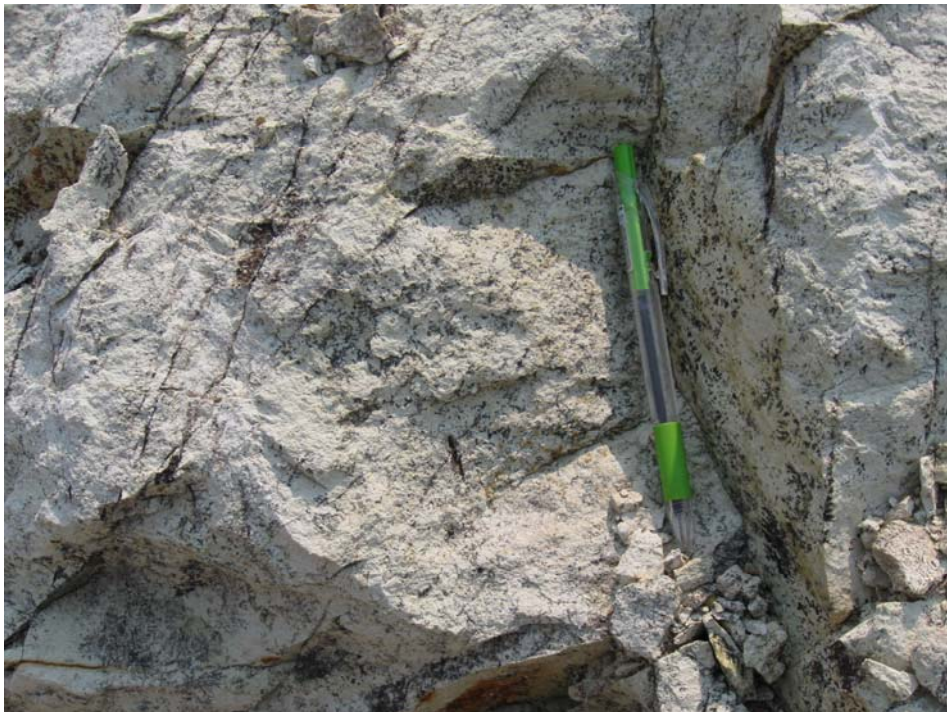
รูปที่ 22 แสดงลักษณะแร่หินอุตสาหกรรมชนิดหินไรโอไลต์เพื่ออุตสาหกรรมเซรามิก พบแร่ไพโรลูไซต์ (Pyrolusite) มีลักษณะเป็นปื้นสีดำ รูปคล้ายกิ่งไม้หรือขนนก ผั่งประในเนื้อหิน บริเวณค่าพิกัด 560302E 2045325N
