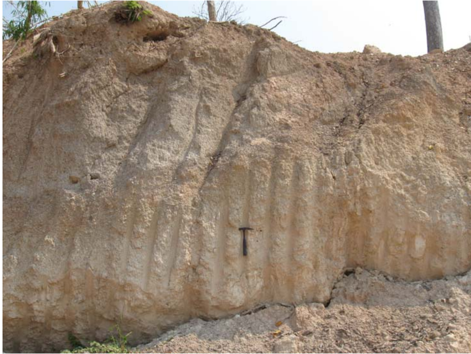
รูปที่ 17 แสดงลักษณะแร่หินอุตสาหกรรมชนิดหินไรโอไลต์เพื่ออุตสาหกรรมเซรามิก สีขาวอมชมพู ก่อนข้างผุ ในพื้นที่คำขอประทานบัตรที่ 6/2561 หมายเลขหลักหมายเขตเหมืองแร่ที่ 30539 บริเวณค่าพิกัด 560330E 2045381N
